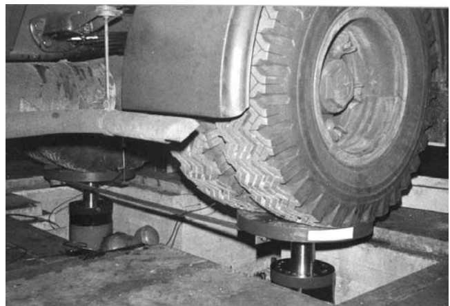
Abb. 10: Harmonische Anregung der Hinterachse..
