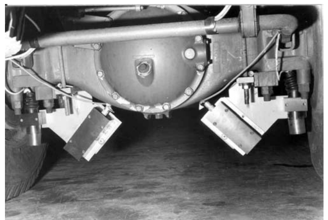
Abb. 13: Optoelektronische Systeme für die Messung dynamischer Radlasten, hier an den beiden Hinterrädern eines Zweiachsers.
